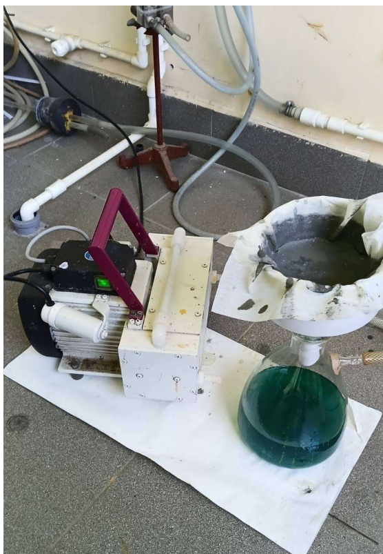
Слика 6.6. Вакуумско филтрирање суспензије после завршетка лужења концентрата бакра: вакуум-пумпа, Бихнеров левак са чврстим остатком и вакуум-боца са филтратом (фотографија аутора)
