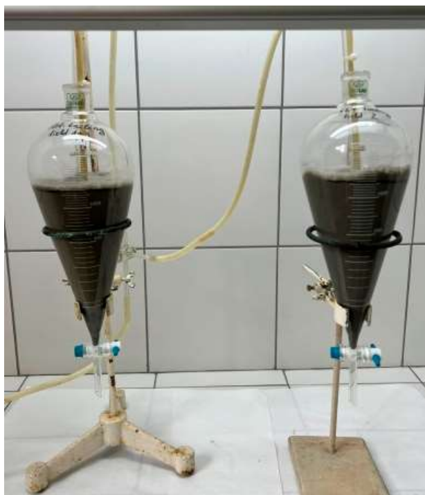
Слика 3.1. Сепараторски левкови за озонско лужење узорака Композит I и Композит II [17]
