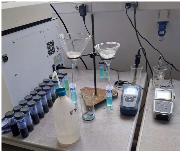
Слика 6.4. Процеђивање лужних раствора и припрема узорака за хемијску анализу; у позадини су узорци раствора узети током лужења и инструменти за мерење рН и редокс потенцијала (фотографија аутора)
