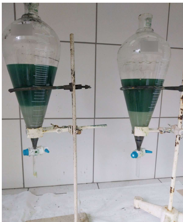
Слика 6.5. Раздвајање фаза у реакционим судовима један сат после завршетка лужења концентрата бакра (фотографија аутора)
