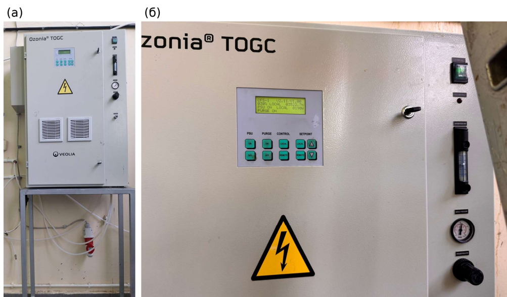
Слика 6.1. Генератор озона Ozonia TOGC 45X (Veolia) коришћен у завршним испитивањима лужења концентрата: (а) изглед уређаја; (б) управљачки панел са ротаметром и манометром напојног гаса (фотографије аутора)
