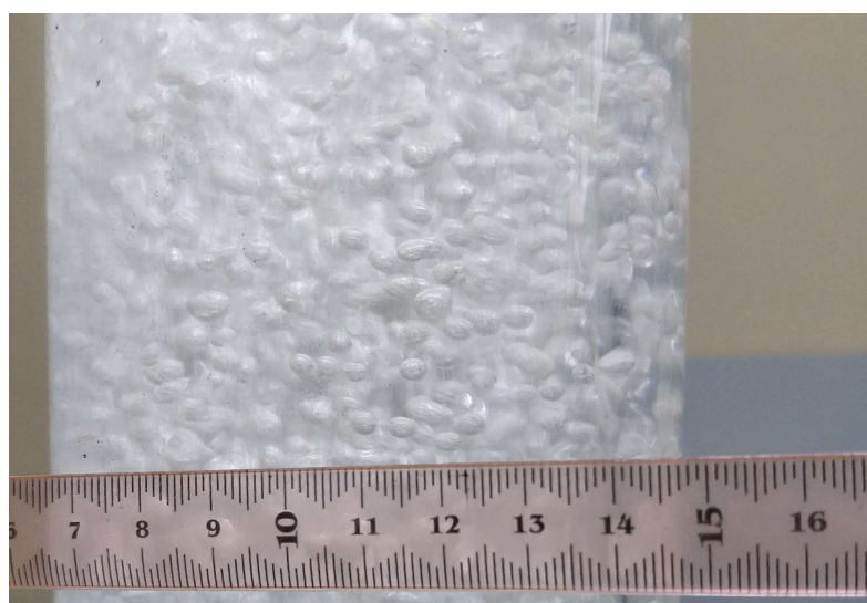
Слика 6.3. Дисперзија мехурића озонизованог гаса у реакционом суду; лењир је постављен уз зид суда ради процене величине мехурића (фотографија аутора)
