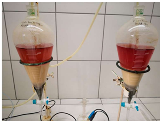
Слика 4.7. Раздвојене фазе после лужења Композита I и Композита II [17]
