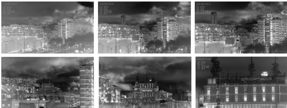
Slika 8 – Primeri slika sa termalnog video kanala posmatranja iste scene sa različitim vidnim uglovima, od širokog, gore levo, do uskog, dole desno
