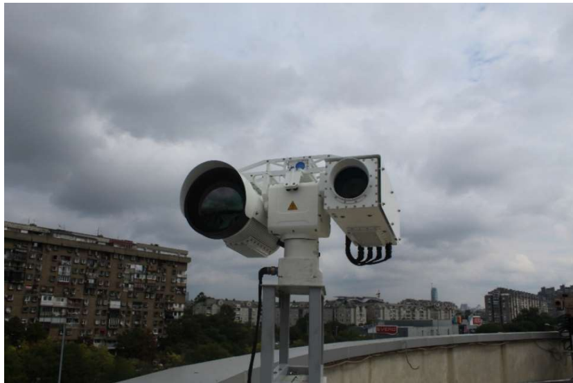
Slika 23 – Eksperimentalna postavka multisenzorskog EO sistema tokom stacionarnih terenskih merenja.
