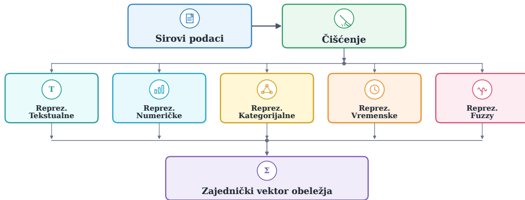
Slika 3.2: Proces konstrukcije obeležja za heterogene podatke.
