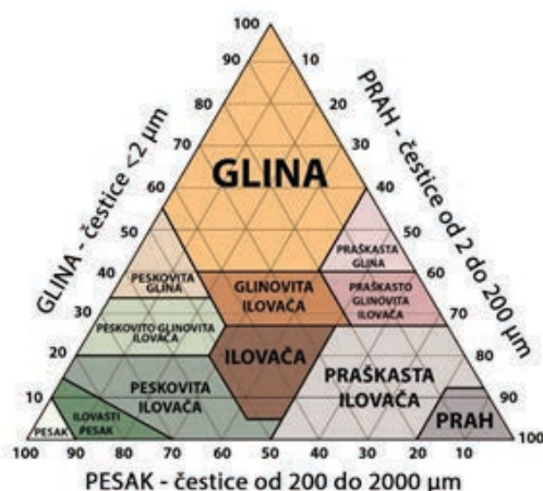
Slika 2.5. Triangularni dijagram za određivanje tekture zemljišta u zavisnosti od procentnog udela pojedinih frakcija sitne zemlje
