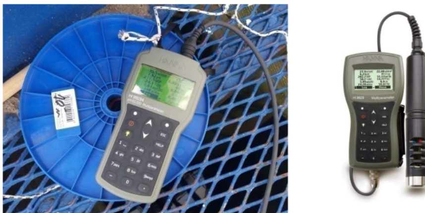
Slika III.5. Multiparametarska sonda HANNA - HI9298194
