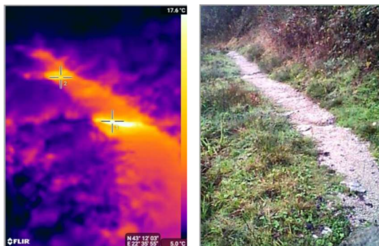
Slika IV.16. Prikaz termovizijskih merenja na potezu od letve 1 do letve 2 (termalna isticanja po obodnoj zoni doline Dobrodolske reke)
