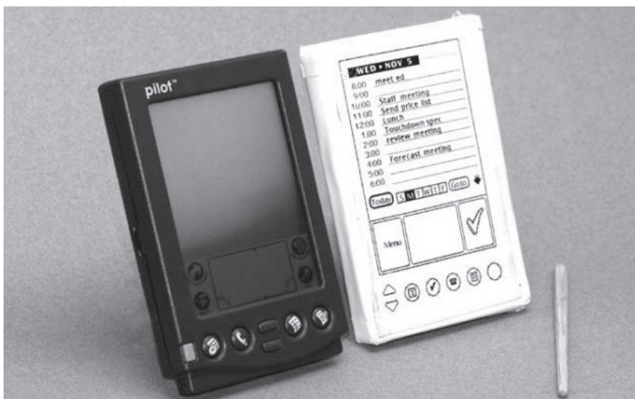
Slika 70. PalmPilot uređaj (levo) i prototip od drveta (desno). Preuzeto i adaptirano iz [48].
