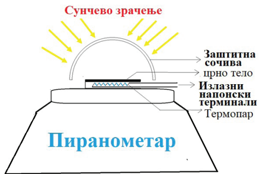
Слика 31. а) Campbell-Stokes-ов хелиограф, б) пиранометар и в) пирхелиометар
