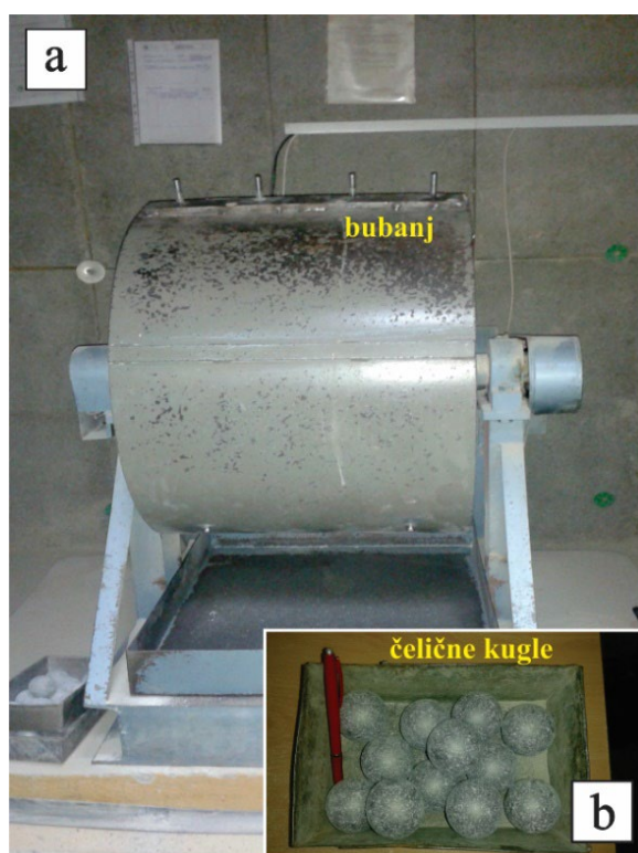
Слика 8 -Машина за испитивање отпорности на дробљење методом Лос Анђелес
