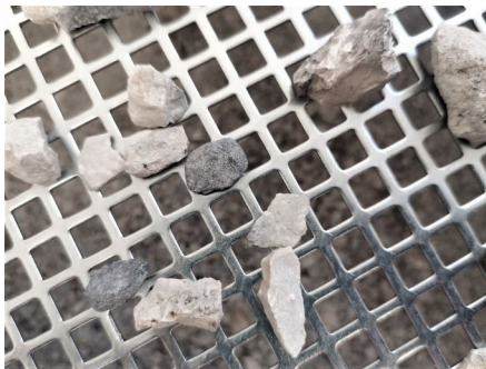
Слика 10: Заостали агрегат узорка на ситиу
