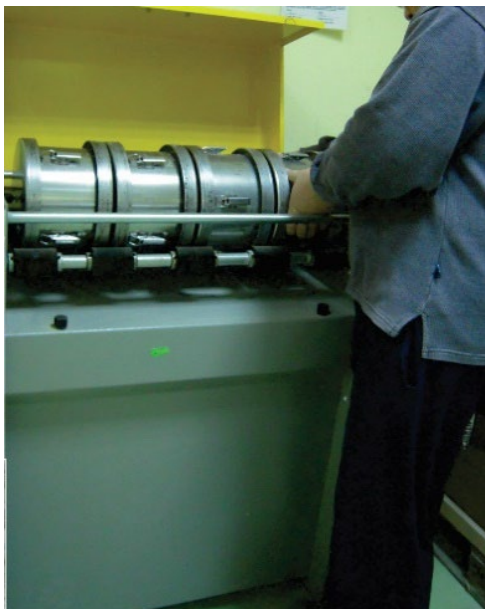
Слика 9 - Машина за испитивање отпорности на хабање микро-Deval
