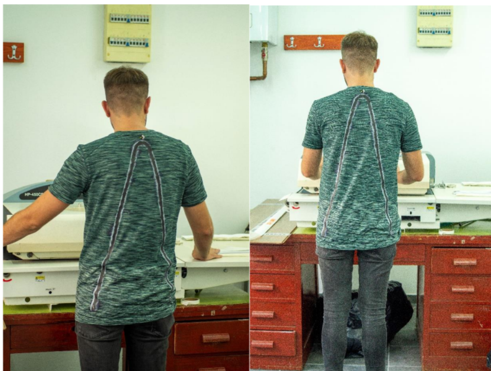
Slika 29. Pozicija senzora na leđnom delu majice
