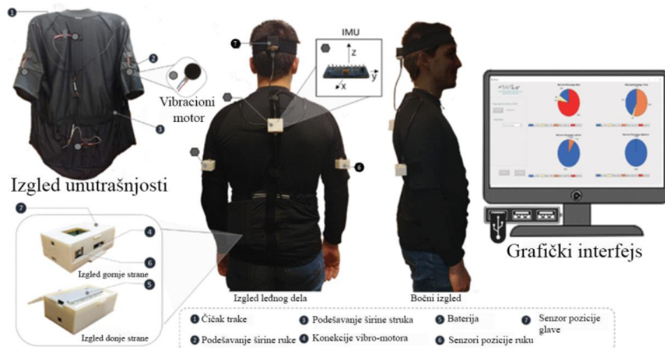
Slika 1. Cerkueira i sar. [48] leđni, bočni i unutrašnji prikaz razvijenog nosivog uređaja i grafički interfejs (GUI) njegove aplikacije.
