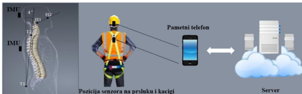
Slika 5. Ian i sar. [64] Pozicije senzora na zaštitnom šlemu i radnom prsluku.
