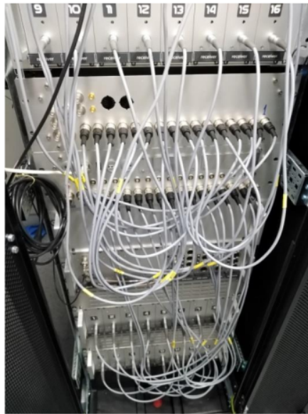
Slika 4.3 Višekanalni analogni prijemni sistem
