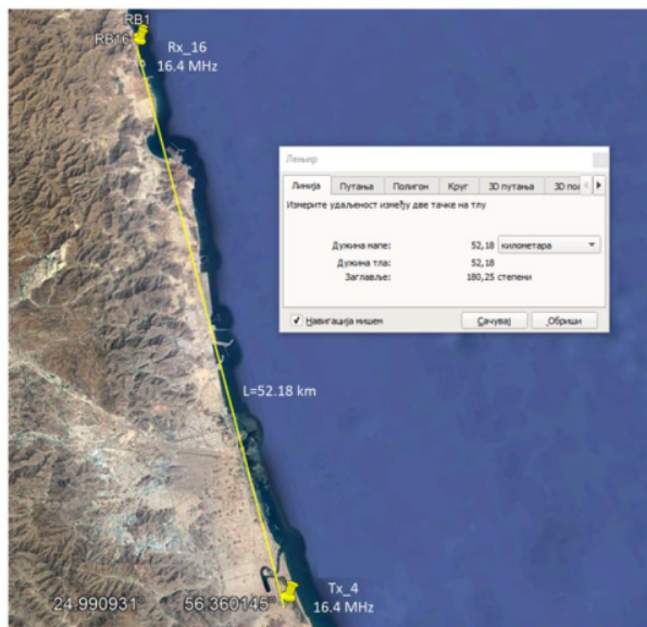
Slika 4.17 Razmeštaj Rx i Tx elemenata instalirane bistatičke arhitekture OTHR radara
