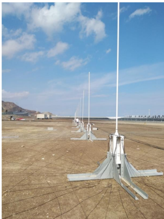
Slika 6.1 Prostorni razmeštaj linearnog 16-elementnog prijemnog antenskog niza
