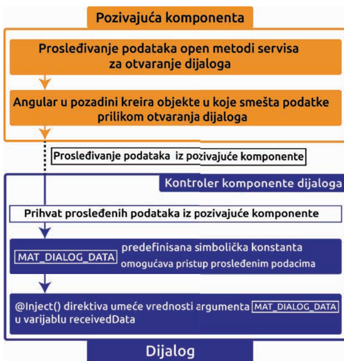
Slika 6.12. Šema prosleđivanja podataka od pozivajuće komponente ka dijalogu.
