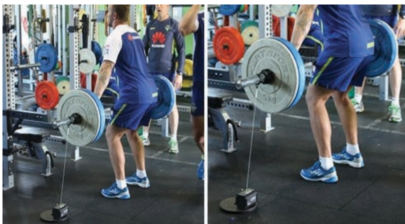
Slika 12 – Linijski pozicioni pretvarač na slobodnom teretu (šipki) 4
