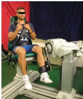
Slika 83 – Postavka izokinetičkog dinamometra za merenje momenata sile u zglobu kolena
