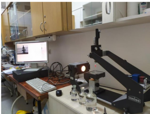
Slika 45: Uređaj Krüss DSA 25 za merenje kontaktnog ugla sa pripadajućim softverom
