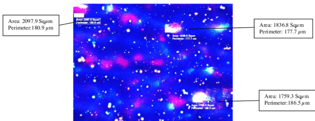
Slika 50: Primer preklopnog otiska M/C na OPP foliji sa selektovanim nepokrivenim (belim) površinama i površinama pokrivenim samo jednom bojom (M ili C)
