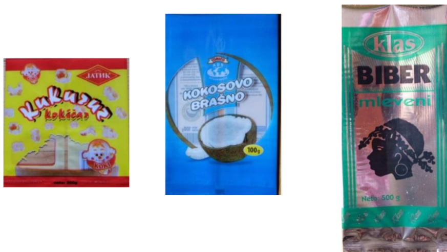
Slika 26: Ispitivani materijali: a) BOPP 40 \mu\text{m} , b) PET/PE, c) PETmet/PE
