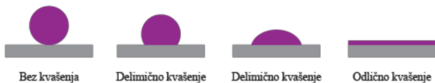
Slika 24: Različiti vidovi kvašenja boje na štamparsku površinu
