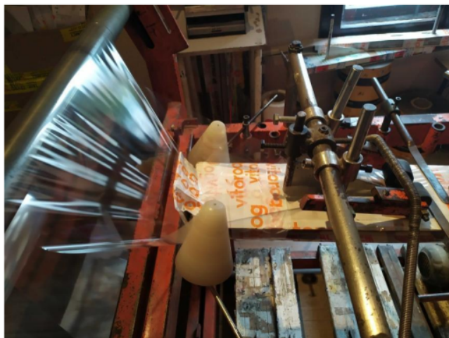
Slika 30: Mašina za formiranje kesica
