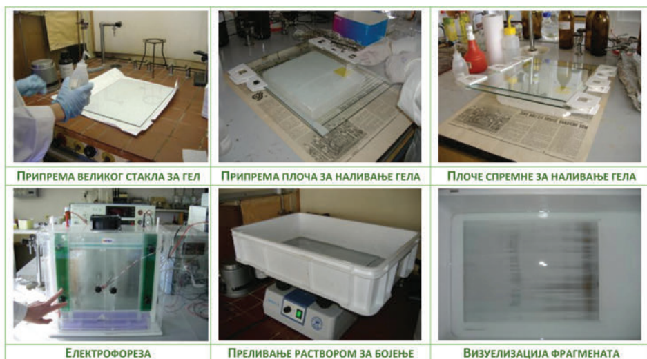
Слика 36. Пример процена унутарврсне варијабилности применом SSR маркера и електрофорезе на полиакриламидном гелу
