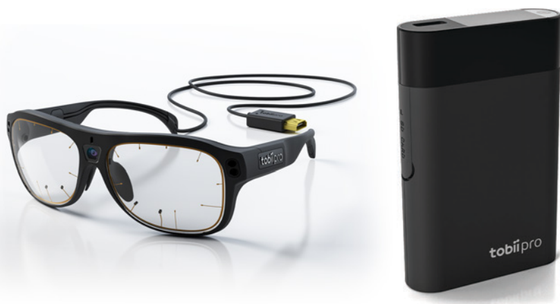
Slika 88. Primer prenosivog uređaja za snimanje pogleda Tobii Pro Glasses 3 . Naočare (levo) poseduju kamere koje snimaju oči korisnika, kao i kameru koja snima ono što korisnik vidi. Naočare se povezuju sa uređajem (desno) koji snima podatke i obezbeđuje napajanje električnom energijom iz baterije.
