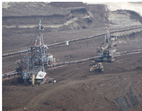
Slika 17.16: Eksploatacija uglja bagerima na otvorenom kopu (foto: B. Vakanjac)
