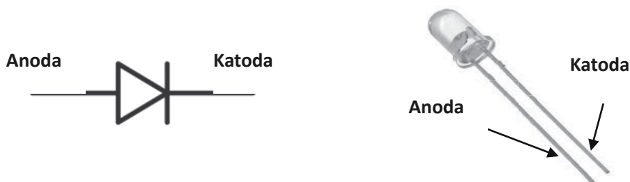
Slika 4 - 2 - Simbol diode (levo) i fizički izgled diode (desno)
