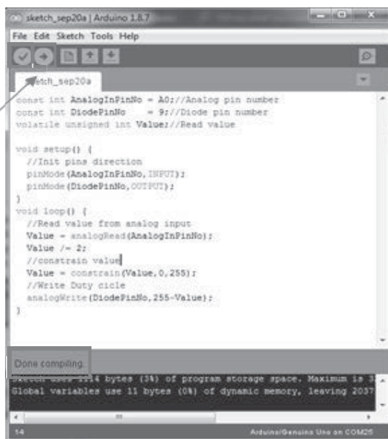
Slika 2 - 9- Primer uspešnog kompajliranja Arduino programa
