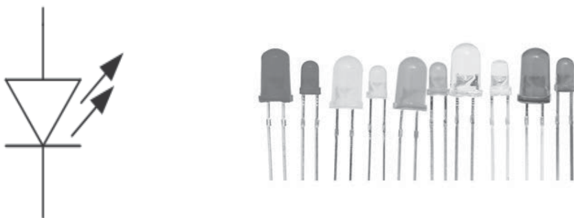
Slika 4 - 4 - Električni simbol LE diode (levo) i LE diode različitih boja (desno)
