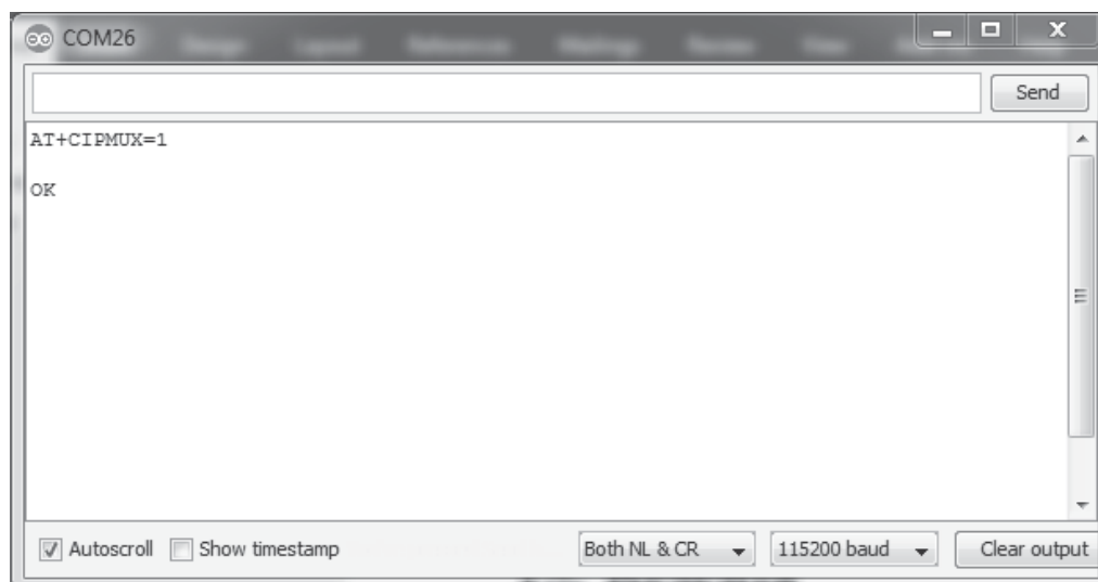
Slika 14 - 7 - Izgled Arduino IDE Serial monitor-a nakon podešavanja broja klijenata
