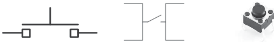
Slika 5 - 1 - Električni simboli (levo i u sredini) i fizički izgled (desno) tastera
