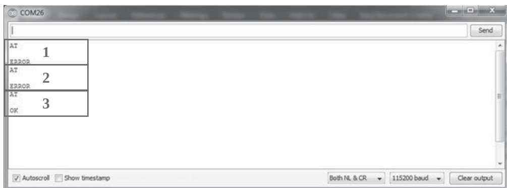
Slika 14 - 4 - Arduino IDE Serial monitor posle slanja komande AT
