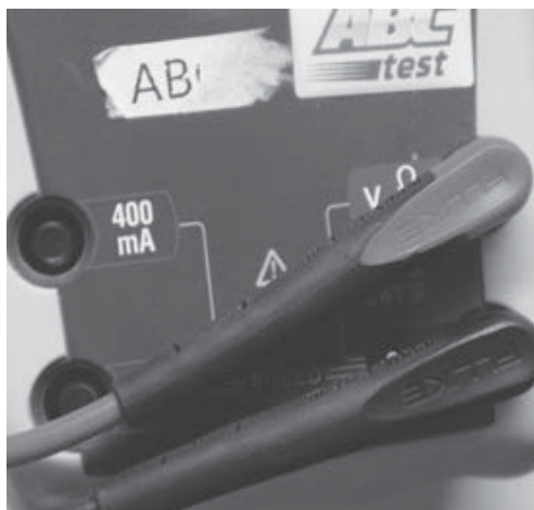
Slika 3 - 11 – Način povezivanja kablova sa multimetrom
