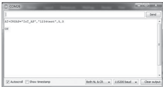
Slika 14 - 6 - Izgled Arduino IDE Serial monitor-a nakon podešavanja SSIDa i password-a
