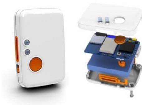
Slika 22. Tipski nosač senzora platforme Shimmer3 [38]
