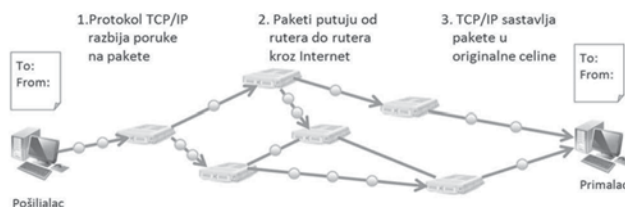
Slika 3.6. Rutiranje Internet poruka u paketnoj TCP/IP mreži
