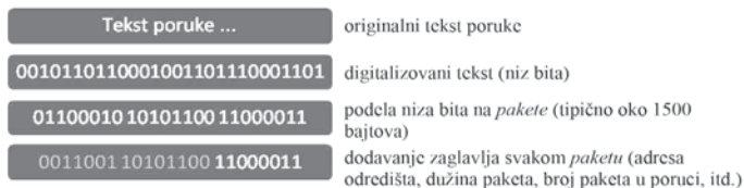
Slika 3.4. Ilustracija paketnog prenosa podataka
