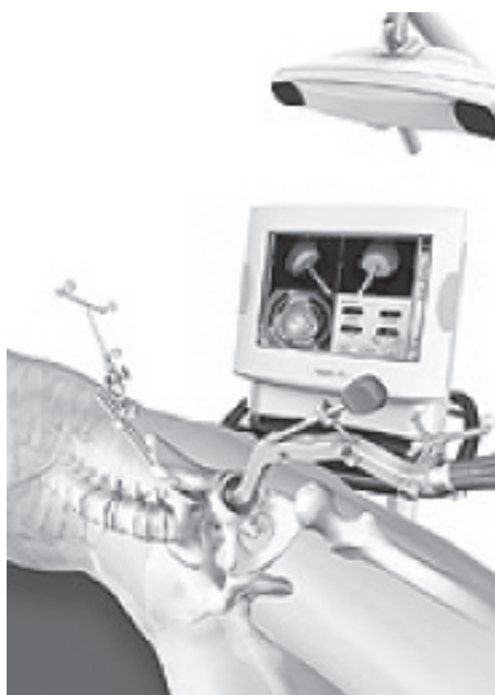
Sl.3.14 HipNav je robotski sistem koji asistira hirurzima prilikom ugradnje veštačkih kukova. Razvijen je na Carnegie Mellon University, USA.
