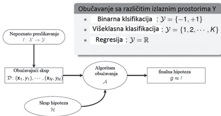
Sl.10.1 Principijelni dijagram ključnih elemenata u induktivnom učenju funkcionalnih preslikavanja: f – nepoznato preslikavanje, D – obučavajući skup ulazno – izlaznih parova, H = \{h\} – skup hipoteza unutar koga biramo finalnu hipotezu g \approx h posredstvom algoritma obučavanja.
