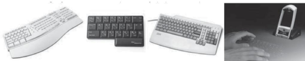
Slika 2.1. Neki od tipova tastatura: ergonomiska, jednoručna, standardna i holografska [1]
