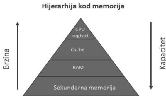
Slika 1.10. Brzine pristupa i kapaciteti glavnih tipova memorija računara
