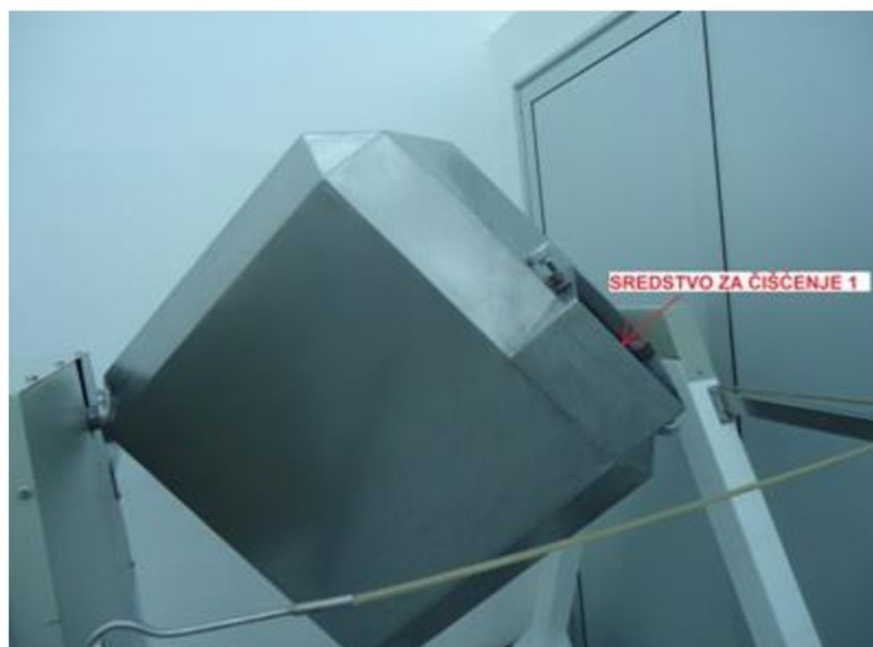
Slika 23- Mešalica tipa kocke – unutrašnjost mesto uzorkovanja HI 1
