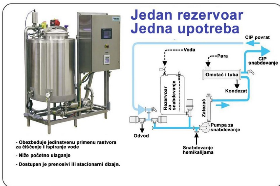
Slika.13: Portabl CIP sistem
