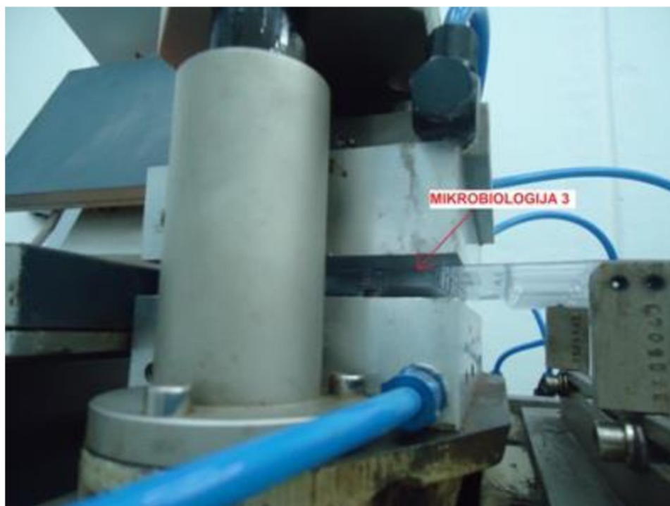
Slika 24– Blisterica – Formiranje gnezda – PVC folija mesto uzorkovanja MB3
