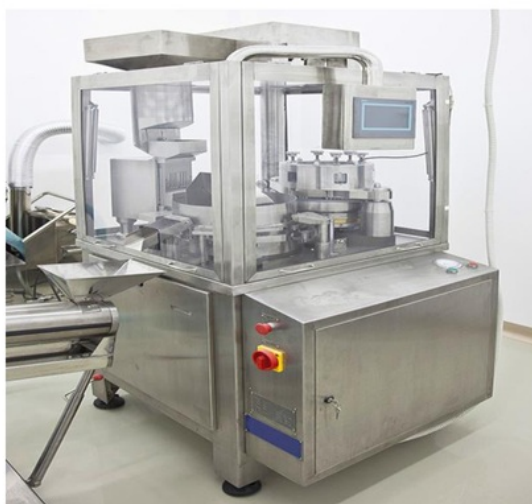
Slika 17: Mašina za kapsuliranje tipa MACOFAR MT 40
