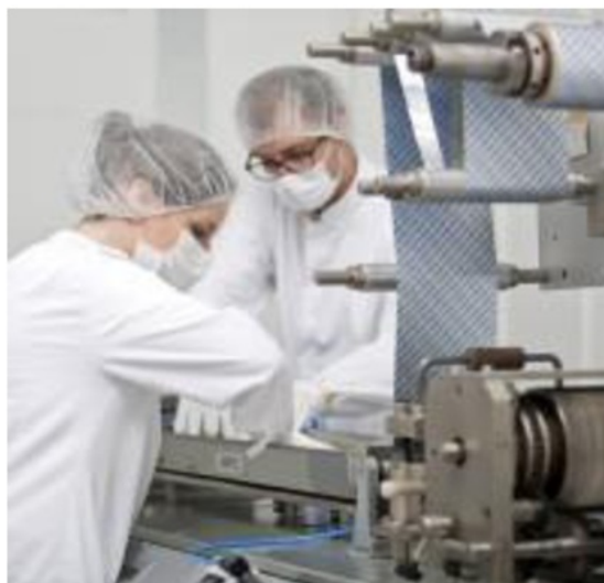
Slika 19: Mašina za blistiranje tipa UHLMANN KP1LA
