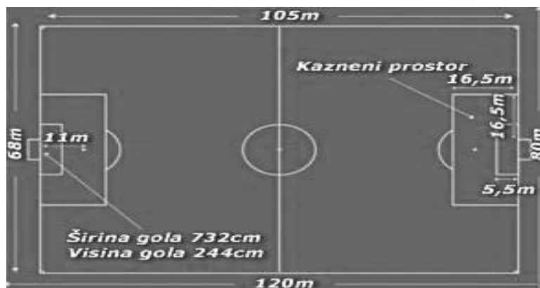
Slika 3. Zahtevane i poželjne dimenzije fudbalskog stadiona
