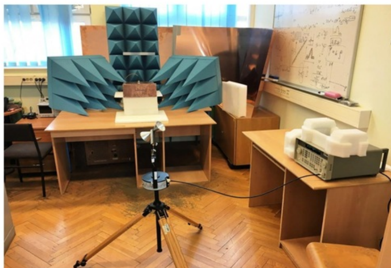
Slika 5.7 Merno mesto sa opremom za merenje tačka po tačka i predajnom antenom bikonusni dipol
