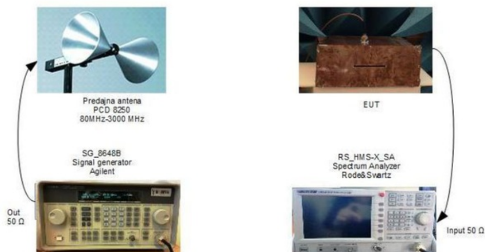
Slika 5.9 Konfiguracija za merenje tačka po tačka
