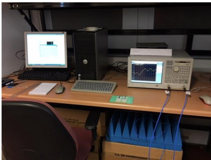
Slika 6.12 Eksperimentalna postavka (računar sa LabVIEW softverom i VNA)
