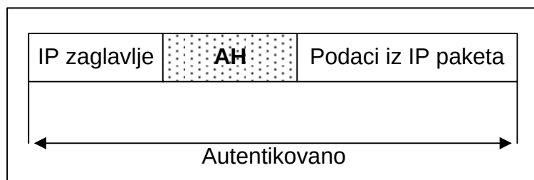
Slika 22: AH - IPv4 paket enkapsuliran AH protokolom u transportnom režimu
