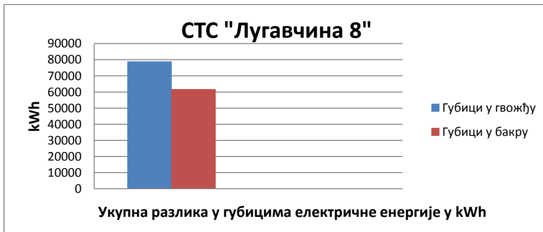
Сл.26 Укупна разлика губитака ел. енергије у бакру и гвожђу трансформатора за просечан радни век трансформатора
