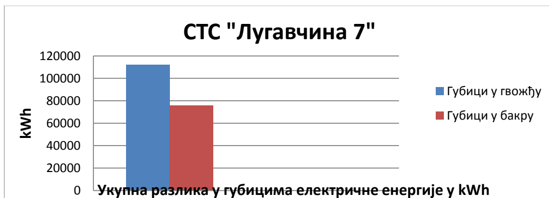
Сл.20 Укупна разлика губитака ел. енергије у бакру и гвожђу трансформатора за просечан радни век трансформатора
