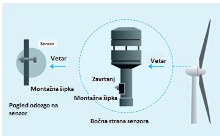
Slika 36. Senzor za merenje vetra 39
