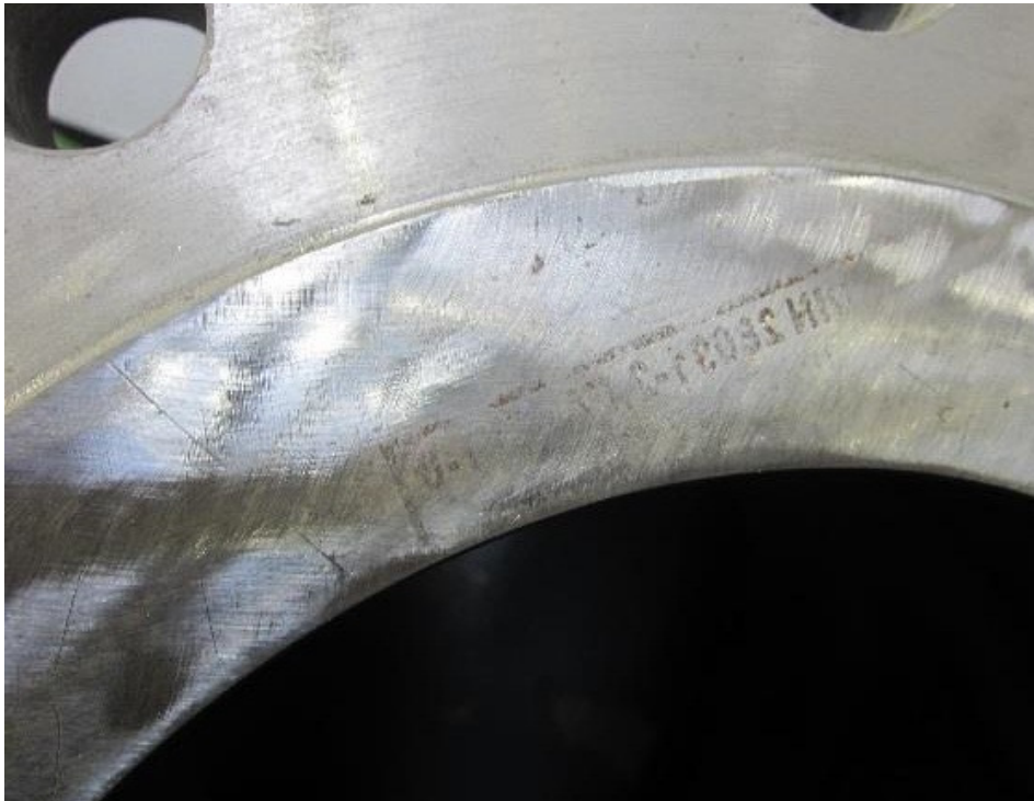
Slika 27: Neravna površina za zaptivanje
