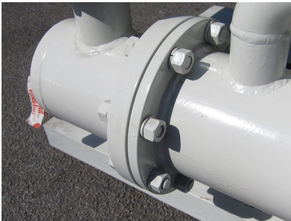
Slika 30: Kratak vijak na spoju prirubnica
