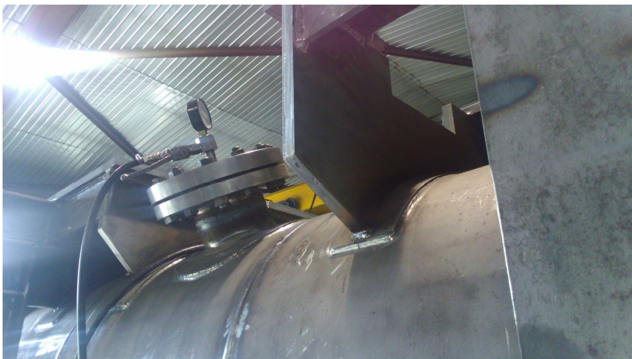
Slika 23: Manometar montiran na najvišu tačku suda
