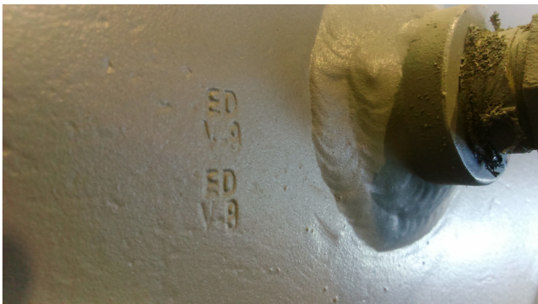
Slika 37: Jedinstveni žig zavarivača
