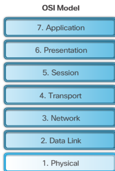
Слика 2.2. OSI референтни модел
