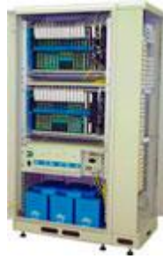
Слика 4.4 Приступни PDH уређај ФМ 8x2 у радној станици
