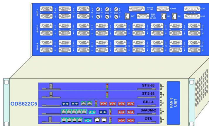
Слика 4.5 Транспортни мултиплексни уређај ОДС 622
