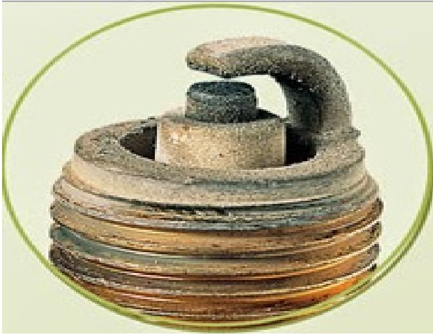
Slika broj 20. : Sistem izostanka sagorevanja- izostanak iskre na svećici, gubitak snage. Izvor- http://srpskipetrolhead.blogspot.rs/ , preuzeto januar, 2015.
