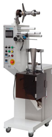
Slika 24. mašina za pakovanje sa vertikalnim tokom (vertical flow-pack)
