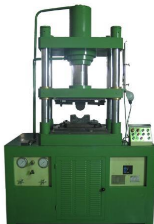
Slika 26. mašina sa dubokim izvlačenjem (deepdrawing machine)
