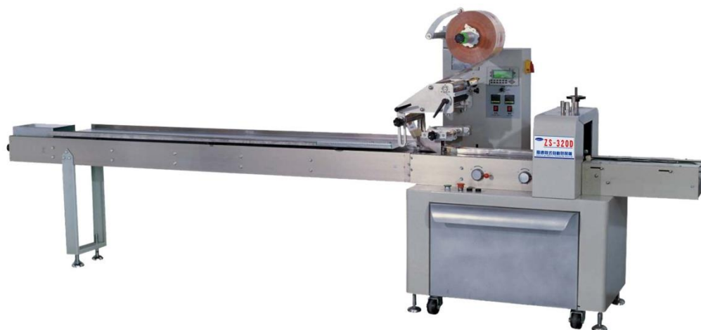
Slika 22. mašina za pakovanje sa horizontalnim tokom (horizontal flow-pack)
