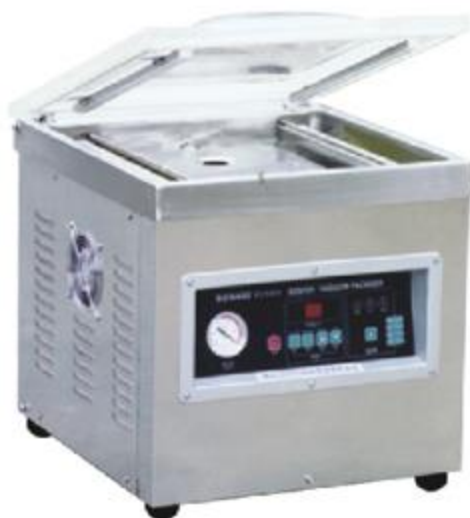
Slika 25. mašina sa vakuumskom komorom za male proizvodne kapacitete proizvoda koji imaju malu cenu
