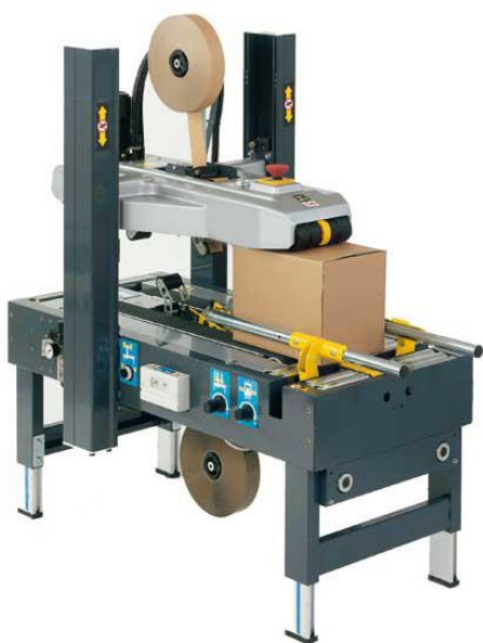
Slika 23. mašina za zaptivanje kutija, kesa u kutiji prilagođena za velike pakete mesa
