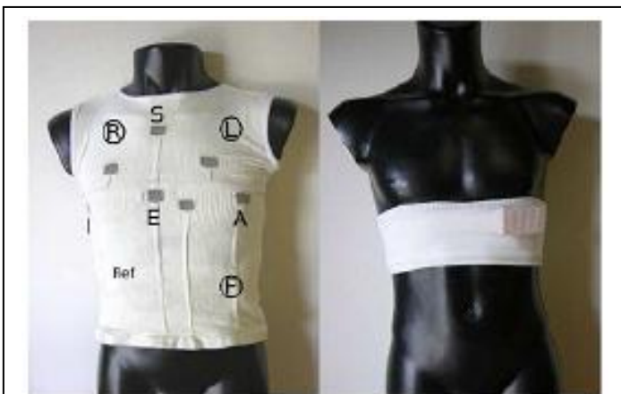
Slika 28. MyHeart prslok na kome se vide mesta senzora i dzepa za procesor
