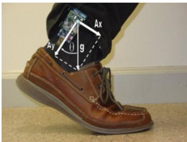
Slika 32. Primer ActiS senzora koji se koristi za rehabilitaciju
