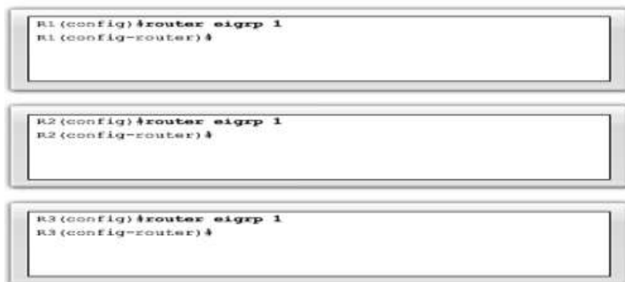
Slika 34 Aktiviranje EIGRP protokola na ruterima R1, R2 i R3
