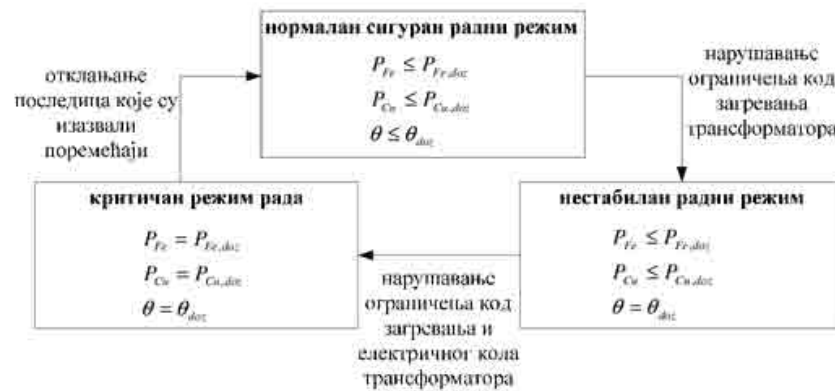
Слика 5.6.1.1. Критеријуми за поуздан рад трансформатора
