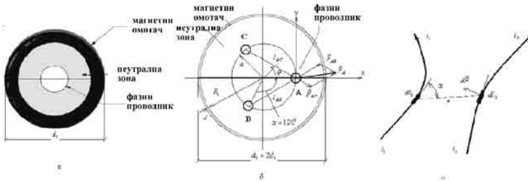
Слика 1.5.1. Омотач (а), који обухвата један проводник, (б) обухвата три симетрична проводника (с) дејство електродинамичких сила између два проводника са струјама i_1 и i_2
