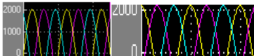
Слика 4.5.4.4.ф. Графички приказ струје за активно R и реактивно X_c оптерећење R=0.16 \text{ Ohm} , 1 \text{ MW} , X_c = 0.16 \text{ Ohm} , 1 \text{ MVar}
