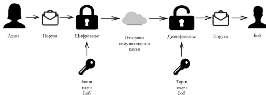
Слика 18. Процес асиметрично шифровање
