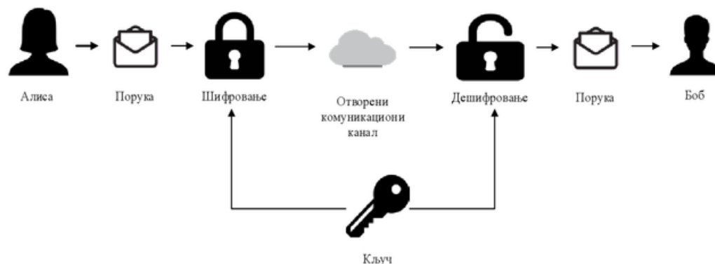
Слика 7. Модел симетричног шифровања
