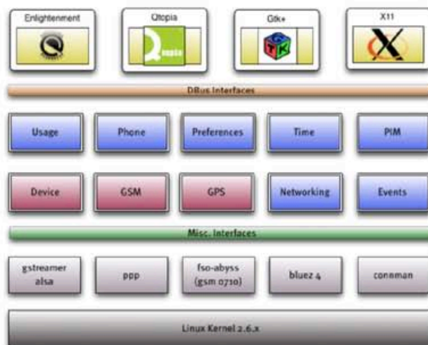
Слика бр.2: Архитектура Оренмоко оперативног система.
