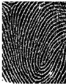
Slika 23a: Slika vlažnog prsta sa senzora osetljivog na pritisak
