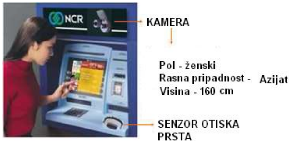
Slika 66: ATM uređaj snabdeven senzorom otiska prsta kao primarnim biom. identifikatorom i kamerom za dobijanje soft identifikatora
