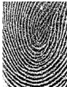
Slika 23b: Slika suvog prsta sa senzora osetljivog na pritisak
