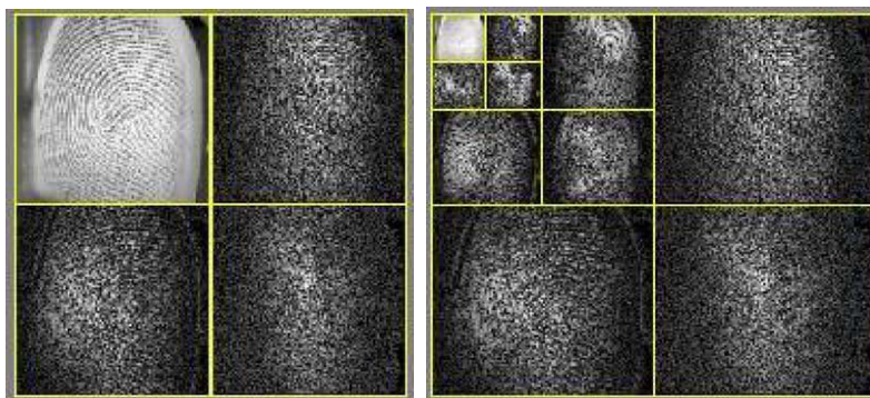
Slika 1 - 2D wavelet transformacija sa jednim(levo) i tri nivoa(desno).
