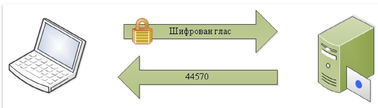
Слика 34. Шифрован глас се шаље изборном серверу, сервер генерише сесијски код “44570” који враћа корисничкој апликацији.
