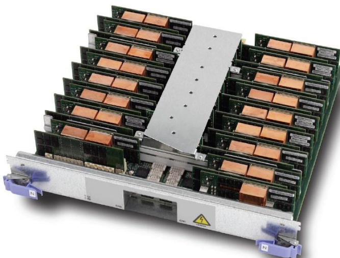
Slika 20. Blue Gene/P node card kućište sa compute modulima.
