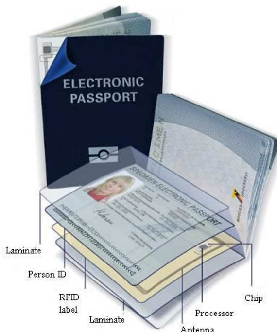
Slika 51 Princip novih biometrijskih pasoša
