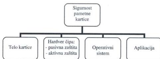
Slika 15 Osnovne komponente sigurnosti smart kartice
