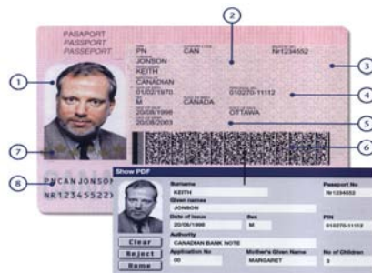
Slika 26 Prikaz dekodiranih podataka iz 2D barcoda
