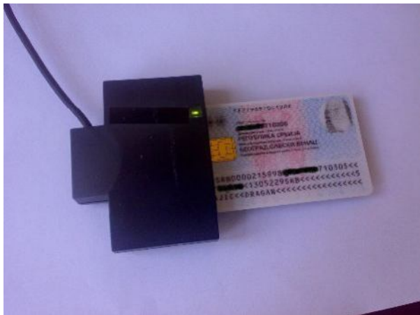
Slika 55 Način očitavanja čipa elektronske lične karte
