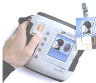
Slika 28 Uzimanje alive otiska prsta i njegovo poređenje sa zapisom na dokumentu
