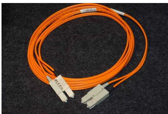
Slika br. 28 – Optički kabl [24]
