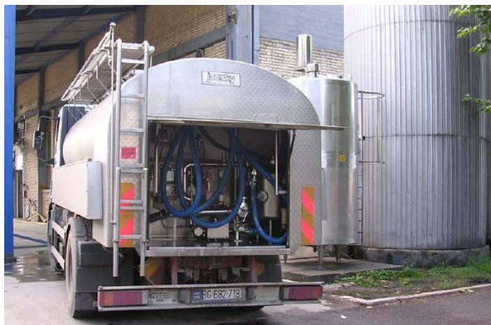
Слика 12. Камсион са кабином за аутоматско узорковање млека, мерење и хлађење
