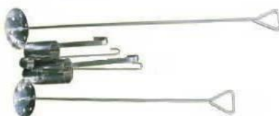
Slika 8. Mešalica i kašika za uzimanje uzoraka iz cisterni kamiona
