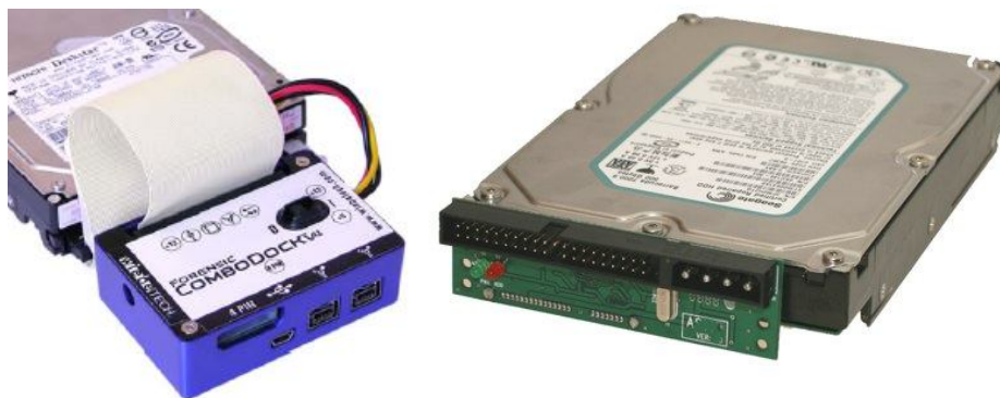
Slika 3. Sakupljanje podataka sa klasičnih 3,5 inča IDE diskova
