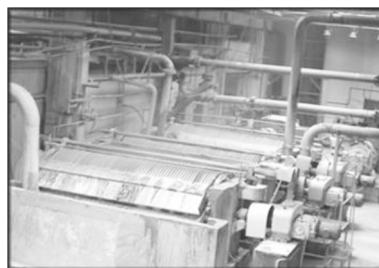
Slika 60.— Prosejavanje i prečišćavanje papirne pulpe (mase).
