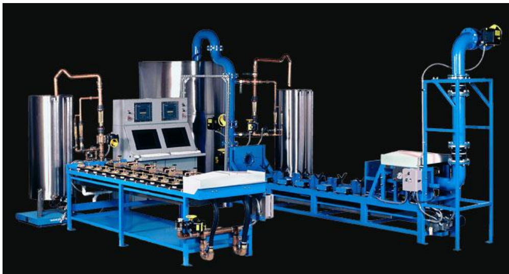
Slika 23 - Ispitna kalibraciona stanica za ispitivanje senzora protoka
