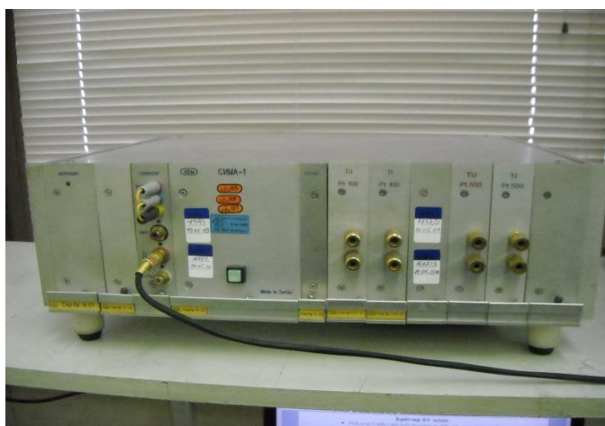
Slika 22 - Univerzalni uređaj za ispitivanje računskih jedinica – merila toplotne energije – Sima
