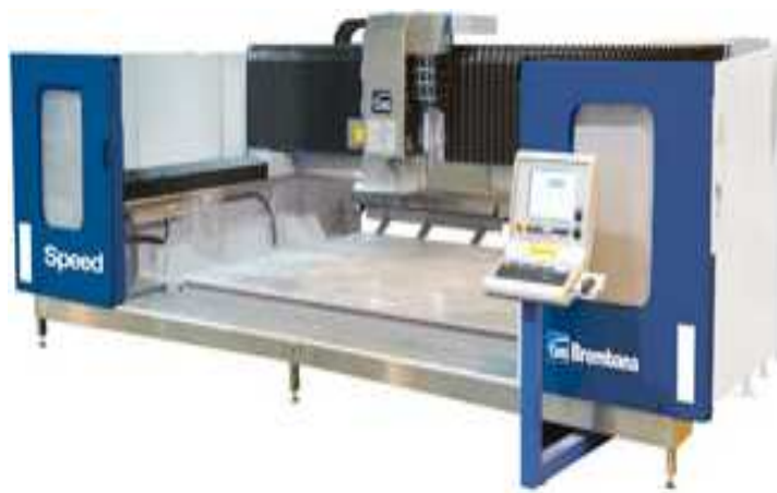
Slika 3.8. Principijelna šema i izgled CNC mašine za sečenje vodenim mlazom [4]
