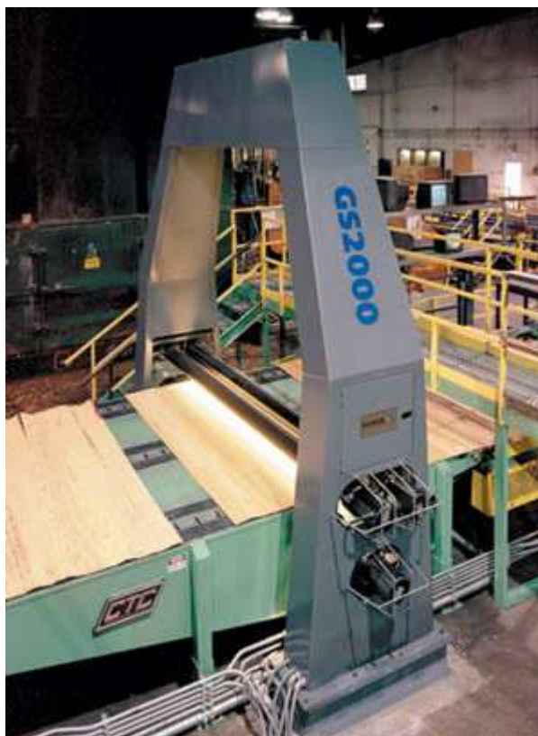
Slika 2.7. Mašinska automatska vizuelna kontrola furnira [36]
