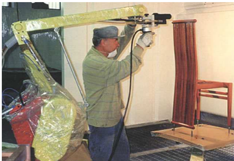
Slika 6.24. Simulacija operacije rada pomoću ručnog vođenja robota za prskanje
