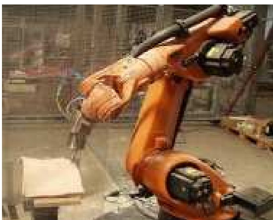
Slika 6.26. Profilisanje delova stolice od savijenog slojevitog drveta pomoću robota (KUKA) [26]
