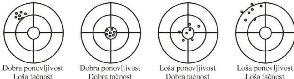
Slika 6.1. Ilustracija tačnosti i ponovljivosti industrijskih robota [7]
