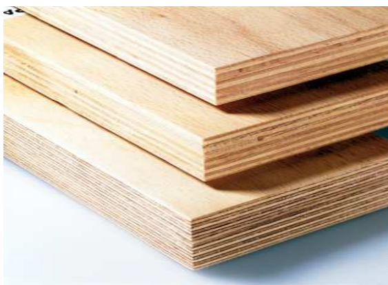
Slika 2.8. Furnirska (šper) ploča: (gore levo troslojna, gore desno petoslojna, dole višeslojna)
