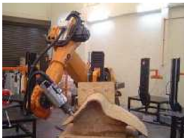
Slika 6.26. Profilisanje delova stolice od savijenog slojevitog drveta pomoću robota (KUKA) [26]
