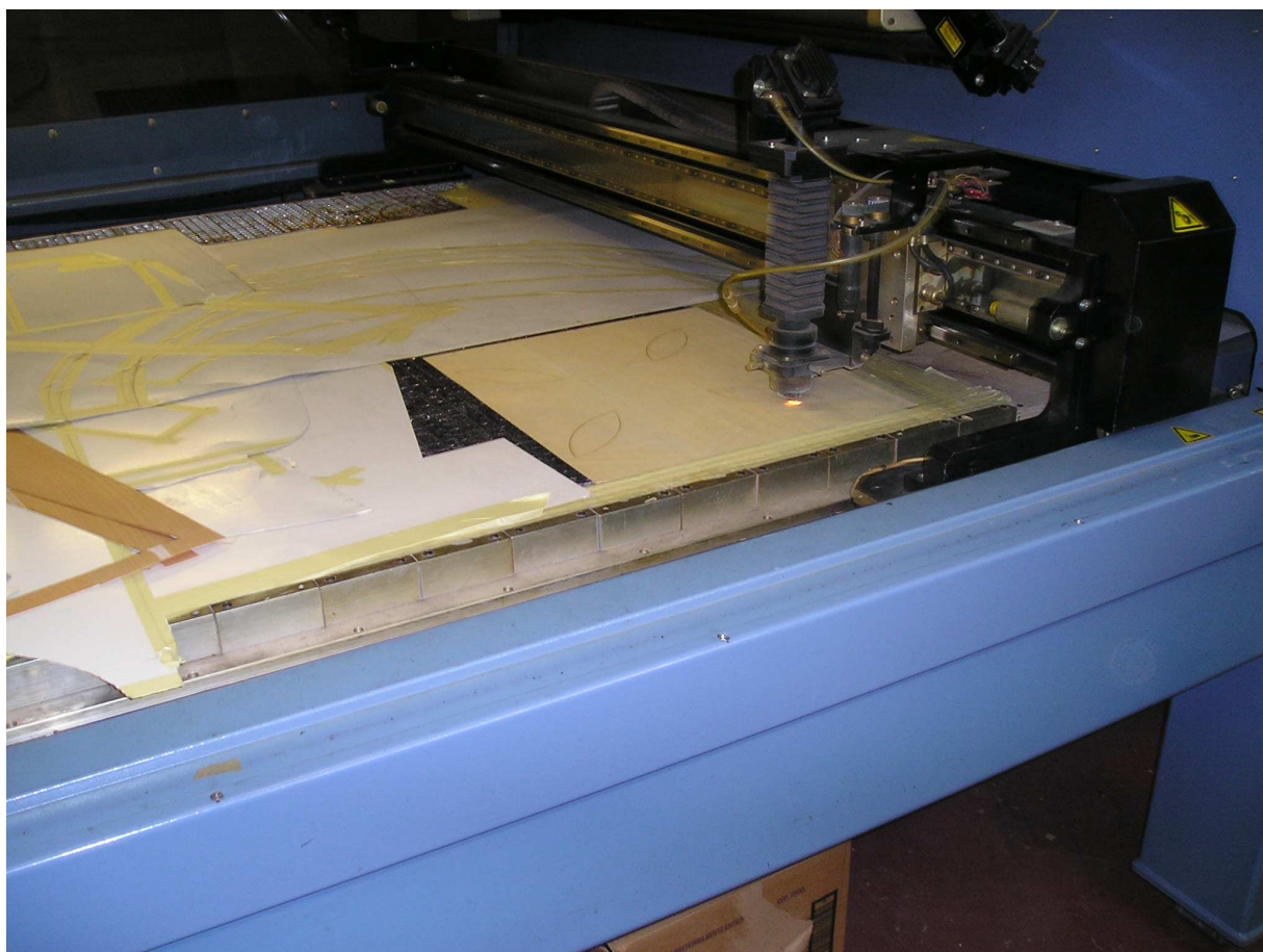
Slika 3.5. Lasersko sečenje bukovog furnira (Elit, Italija)
