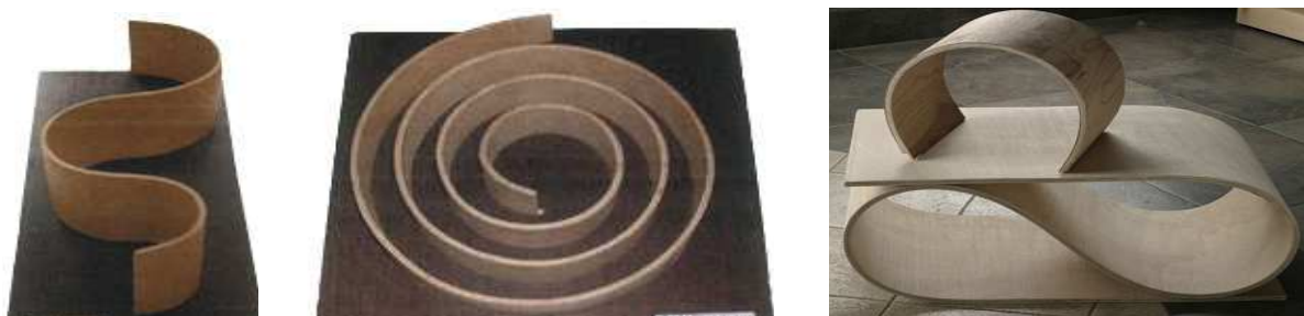
Slika 2.11. Različite vrste specijalne (savitljive) furnirske ploče [15]
