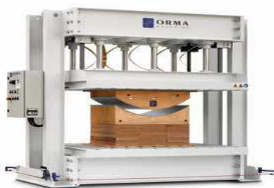
Slika 4.12. Način dobijanja otpresaka od slojevitog drveta (Orma, Italija) [14]
