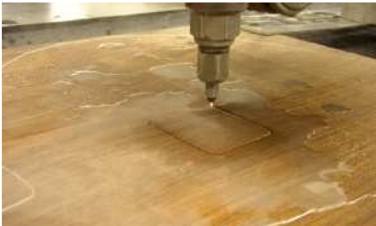
Slika 3.9. Sečenje furnira vodenim mlazom
