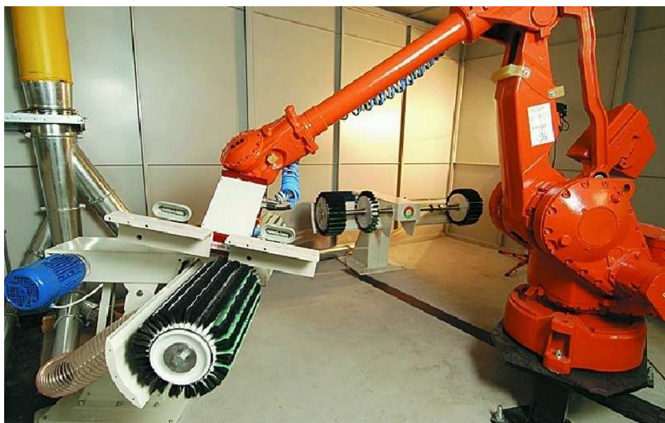
Slika 6.20. Robot brusi predmet na mašini za brušenje [31]
