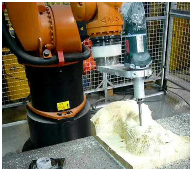
Slika 6.35. Simulacija i obrada modela pomoću robota za izradu duboreza [26]
