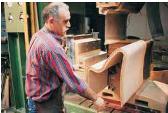
Slika 4.12. Način dobijanja otpresaka od slojevitog drveta (Orma, Italija) [14]
