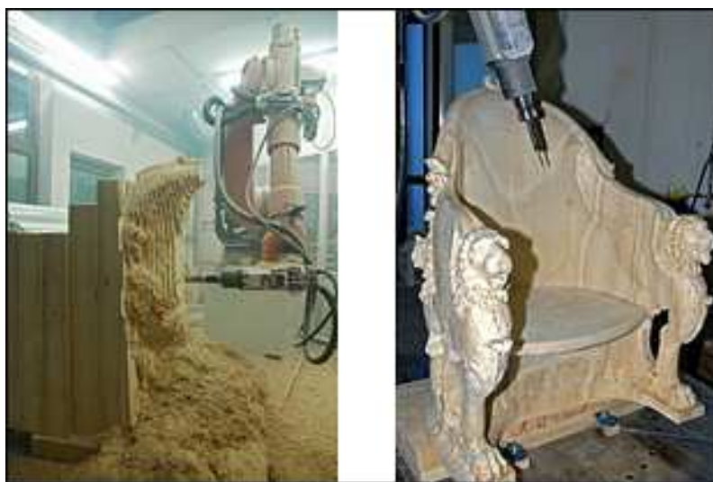
Slika 6.36. Robotska izrada modela i skulptura velikih dimenzija [26]
