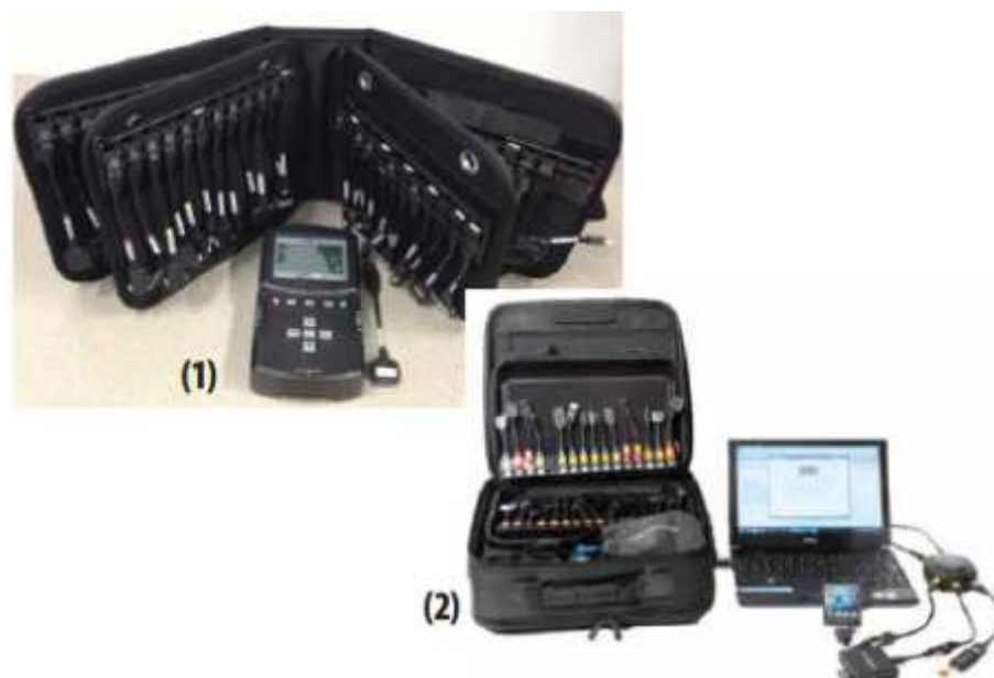
Слика 17. Производи који се користе - 1) Cellebrite UFED , 2) Micro Systemation XRY 29
