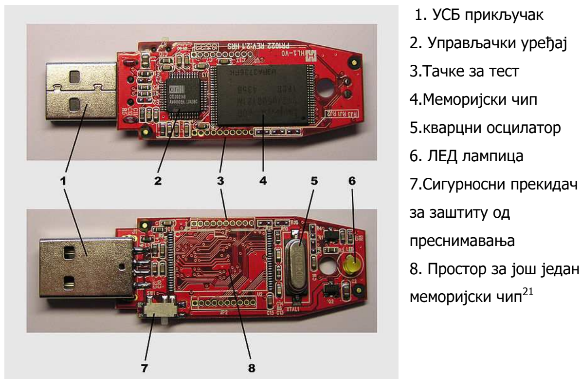
Слика 9. Унутрашњост УСБ стика
